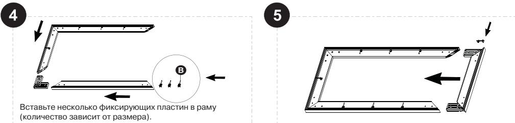
Вставьте несколько фиксирующих пластин в раму (количество зависит от размера).
